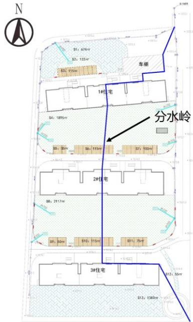
图 C-9 案例三小区雨水径流分水岭示意图
